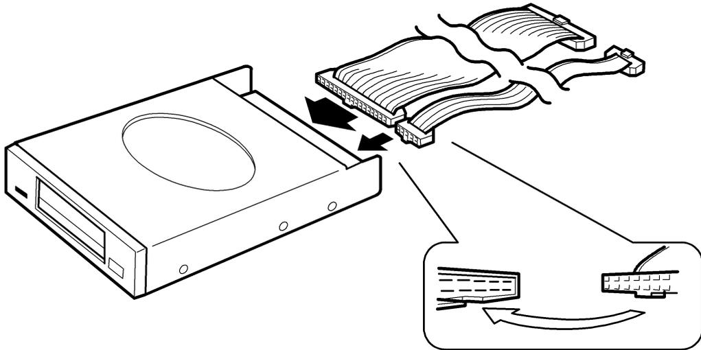
パソコンの3.5インチベイスロットに、ケーブルから挿入しセットします。
