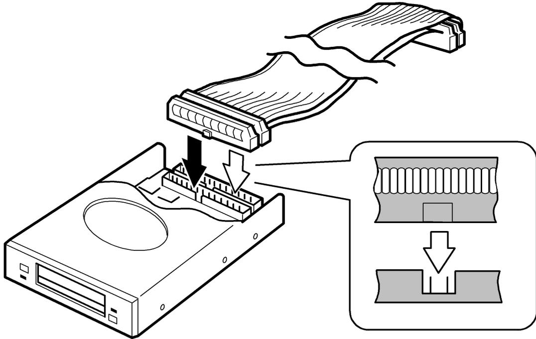
パソコンの3.5インチベイスロットに、ケーブルから挿入しセットします。
