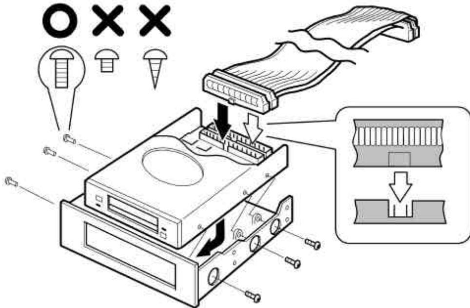
パソコンの5インチベイスロットに、ケーブルから挿入しセットします。
