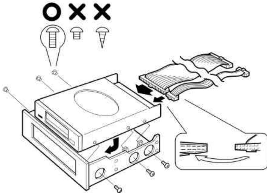
パソコンの5インチベイスロットに、ケーブルから挿入しセットします。
