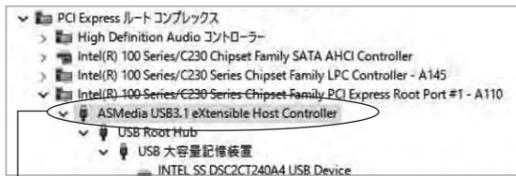
"ASMedia USB3.1 eXtensible Host Controller" と表示されている場合はMSCクラスとして認識されています。"ASMedia USB3.1 eXtensible Host Controller - 1.10(Microsoft)" に入れ替えます。
