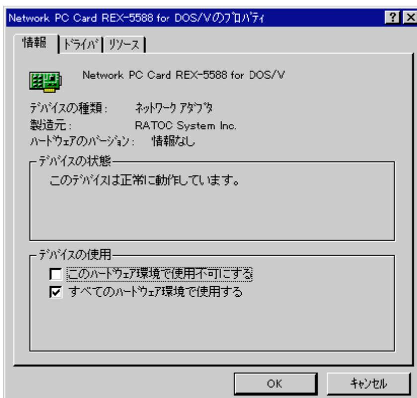
(4).このウィンドウの「デバイスの使用」内にある項目のチェックボックスを切り替えてデバイス(REX-5588)の使用許可を決定します。
