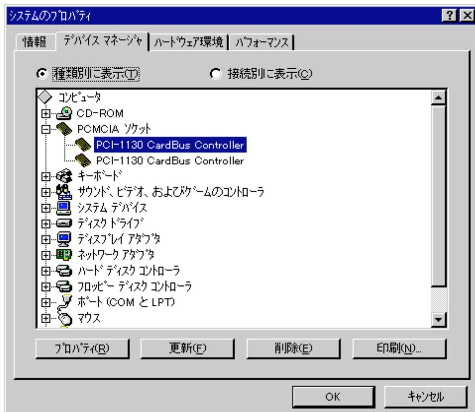
「PCMCIAソケット」の内容が「PCICまたは互換PCMCIAコントローラ」だったり、「PCI-1130 CardBus Controller」の項目に「×」や「！」が付いている場合、REX-CB80を使用することはできません。この場合は「PCカード (PCMCIA)アダプター」でCardBusが正常に使用できるように設定してください。
