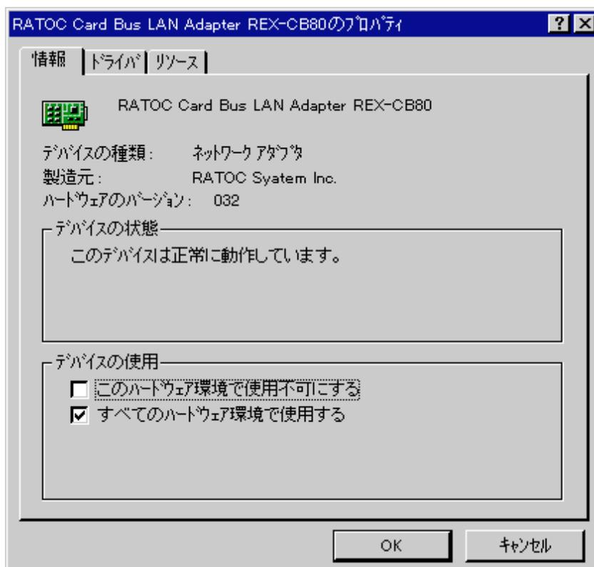
(3)このウインドウの「デバイスの使用」内にある項目のチェックボックスを切り替えてデバイス (REX-CB80)の使用許可を決定します。
