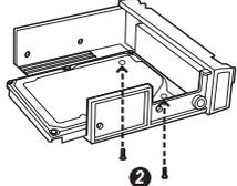
規格外の2.5インチHDD・SSDで、ネジ穴が合わずネジ止めしづらい場合は、HDDを多少動かし、ネジ穴のずれが少ない側からネジ止めます。
