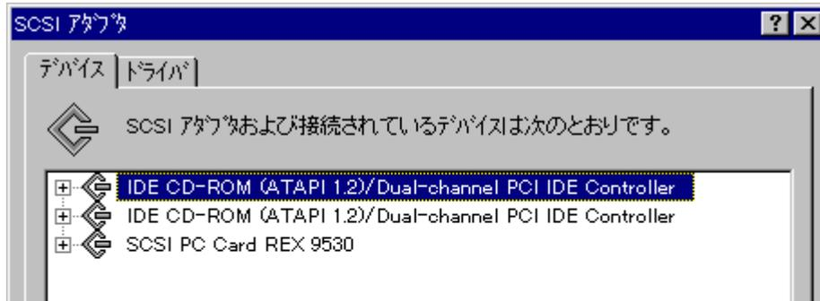
[デバイス] リストの中に [SCSI PC Card REX 9530] が表示されていることを確認します。
