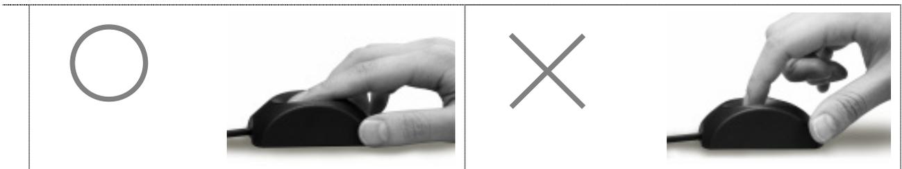
図 1.指の腹の中央をセンサに密着させる
