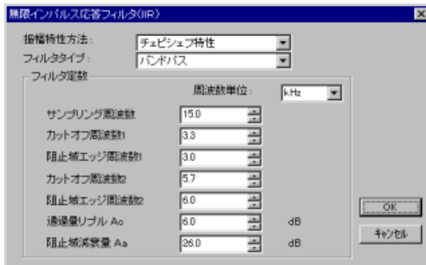
Fig.2-6-11 BPF 振幅特性
