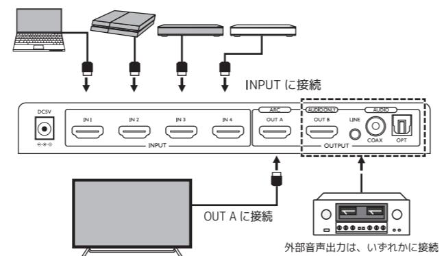
4 AC アダプターを本製品の電源ポート → コンセントの順に接続します。
