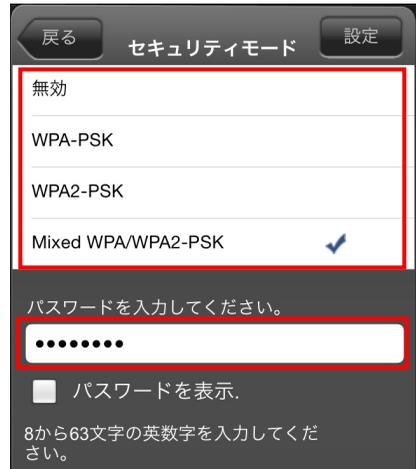
3. パスワード入力後、[設定]をタップすると手順1の画面に戻ります。[戻る]をタップすると“変更内容の確認”画面が表示されますので[OK]をタップします。
