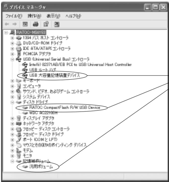
「USB (Universal Serial Bus) コントローラ」に「USB 大容量記憶装置デバイス」、「ディスクドライブ」に「RATOC CompactFlash R/W USB Device」、「記憶域ボリューム」に「汎用ボリューム」が登録されていることを確認します。
