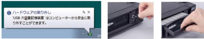
(1)パソコン上でアンマウント(取り外し)後…(2)キーを回して(3)トレイ交換！
