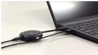
ノート PC に送信機を接続 (映像出力 HDMI、電源用 USB)
