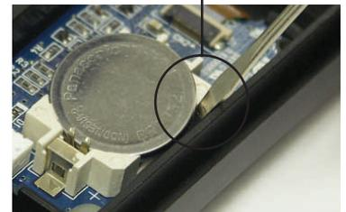
(③の説明写真) 電池の刻印面（+面）を上にして取り付ける。
