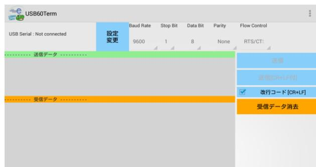
画面左上のUSB Serialという項目の右に「Connected」と表示されていれば、USB Serial Converterが正しく検出されており、データ送受信が可能な状態になっています。(各機能の説明は次ページ以降をご参照ください。)
