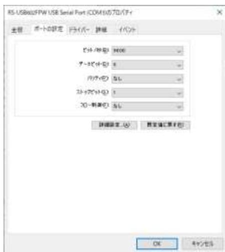
COMポート番号を変更する場合は、「RS-USB602FPW USB Serial Port (COMx)」をダブルクリックします。プロパティ画面の「ポートの設定」タブを選択し「詳細設定」ボタンをクリックします。
