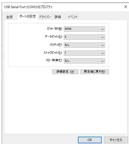
COMポート番号を変更する場合は、「USB Serial Port (COMx)」をダブルクリックします。プロパティ画面の「ポートの設定」タブを選択し「詳細設定」ボタンをクリックします。
