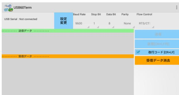
画面左上のUSB Serialという項目の右に「Connected」と表示されていれば、USB Serial Converterが正しく検出されており、データ送受信が可能な状態になっています。
