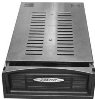
3. ハードディスクのジャンパー設定を[マスター]に設定し、トレイの電源コネクタと IDE コネクタを接続してください。
