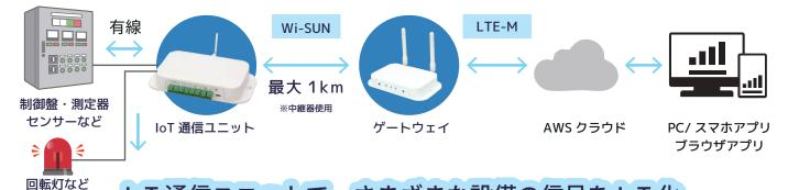
IoT 通信ユニットで、さまざまな設備の信号を IoT 化
