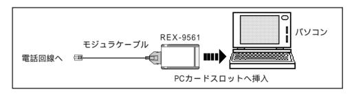
下記カードの正面図を上面にして、PC カードスロット側コネクタをパソコンの PC カード スロットに挿入します。4 ピンコネクタに、付属のモジュラーケーブルを接続します。ケーブルをカードから取り外す時はコネクタの両側を押さえながら取り外してください。
