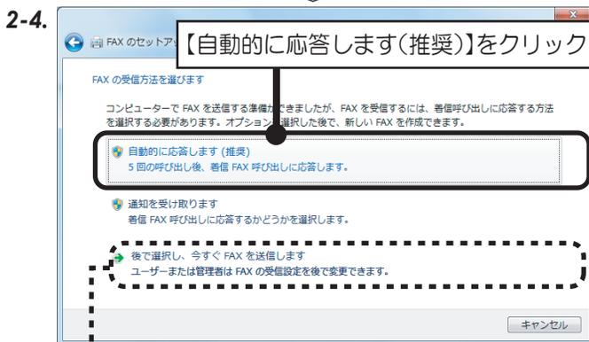
※FAX 受信が不要の場合は、【後で作成し、今すぐFAXを送信します】をクリックしてください。設定は後から変更できます。「1.FAX の設定をする。」の1-4. 画面で”デバイスでFAX 呼び出しを受信できるようにする”にチェックを入れてください。
