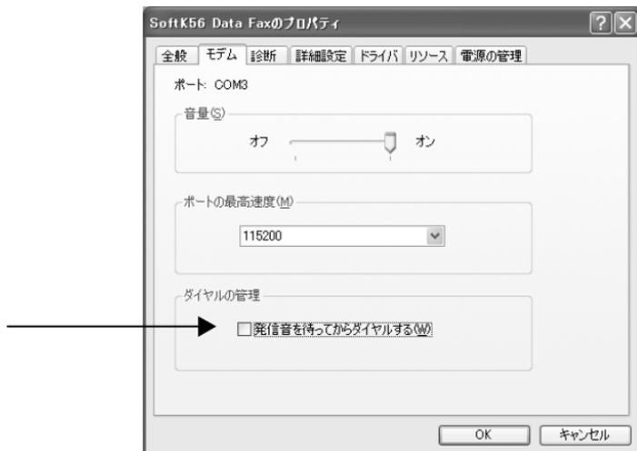
16. 「モデムの照会」を選び以下の画面に変わるのを確認してください。表示後、「OK」をクリックします。
