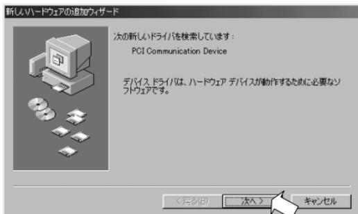
2. 以下の画面が表示されますので「使用中のデバイスに最適なドライバを検索する(推奨)」を選択し「次へ」をクリックしてください。
