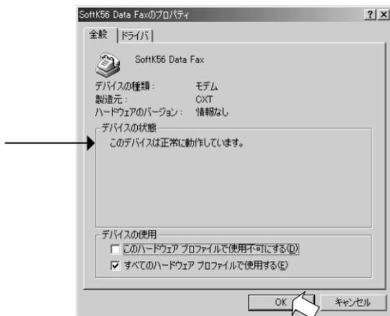
3. 「マイ コンピュータ」をダブルクリックして、「コントロールパネル」を開きます。「モデム」アイコンをダブルクリックします。P.18 のような画面が起動した場合は、「市外局番 / エリアコード」を入力し、「OK」をクリックします。すると次の画面が表示されますので、「SoftK56 Data Fax」を選択し、「プロパティ」をクリックします。
