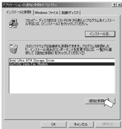
2. コントロールパネルの「モデム」のアイコンをダブルクリック、削除するモデムを選択した後「削除」をクリックします。
