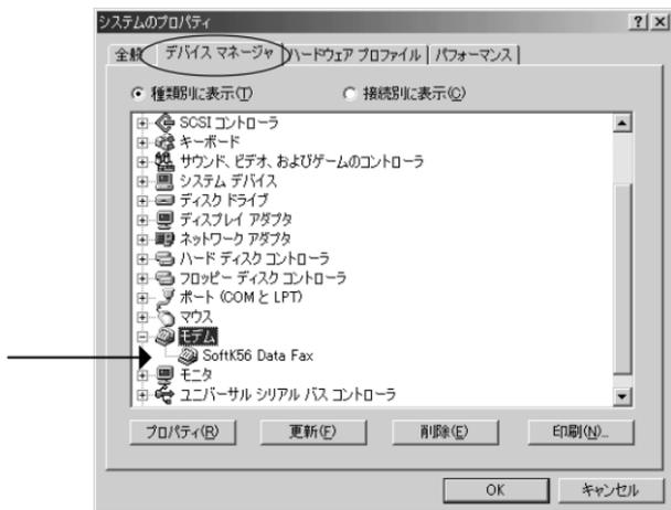
2. 「SoftK56 Data Faxのプロパティ」画面にて「このデバイスは正常に動作しています」と表示されているのを確認します。「OK」をクリックしてください。
