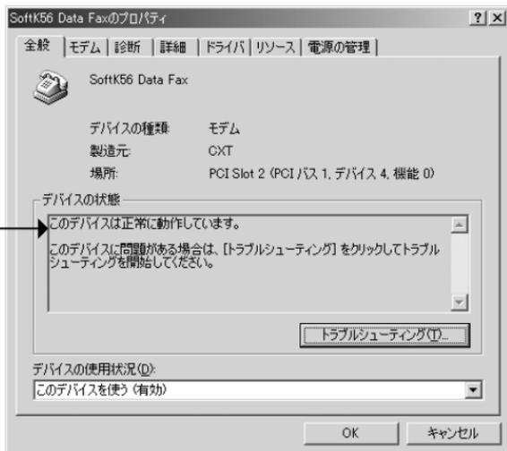
4. 外線発信を行う場合や、はじめに0や9を回す必要のある構内回線を使用している場合は、「ダイヤルの管理」の「発信音を待ってからダイヤルする」のチェックを外します。次に「診断」タブをクリックしてください。
