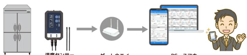
冷蔵設備や倉庫などに温度センサーを設置。既存の設備に手を加えることなく、スマホで 24 時間 365 日のリアルタイム温度監視が可能になります。設定温度を超えた際の即時通知で、重大なロスを未然に防ぎます。
