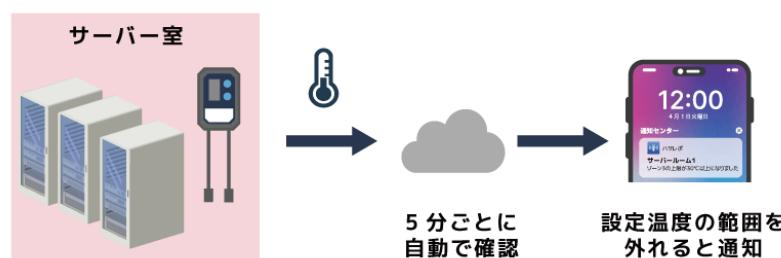
室内に設置した温度センサーの値を常にクラウドで監視。温度異常を検知したら、管理者のスマホへアラートもしくはメールを飛ばします。既存のネットワーク環境に依存せず、独立した通信網で監視できるため、トラブル時の確実な通知手段として最適です。
