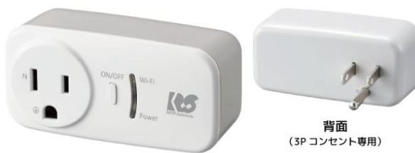
「RS-WFWATCH2」は、機器の電源プラグと 3P コンセントの間に挿むだけで、消費電力、電圧、電流などを計測できる IoT 電力計（スマートプラグ）です。Wi-Fi に接続して使用し、計測したデータは 1 分ごとに本体メモリに保存され、アプリで確認したり CSV で取り出すことができます。
