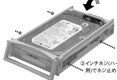
③ インチネジ(ハードディスク用)でネジ止めします。
