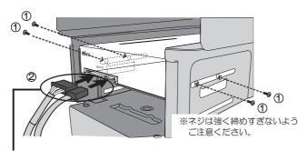
※ラッチ付SATAケーブルを抜く際は、必ずラッチを押さえてください。 ラッチ を押さず無理に抜くとコネクタを破損する恐れがあります。
