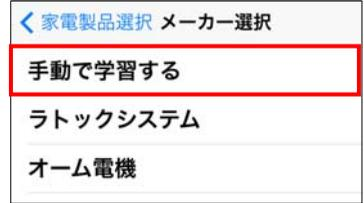
3. [手動で学習する]をタップすると、本体の学習 LED が赤く点灯します。リモコンを向け、学習させたいボタンを押します。学習が完了すると、学習 LED は消灯します。
