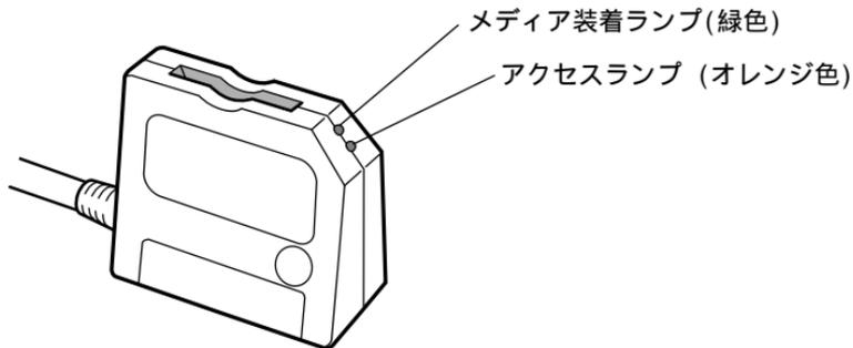
メディア装着ランプ（緑色）は、スマートメディアが確実に挿入されていない場合、点灯しません。スマートメディアが確実に挿入されているか、本製品がパソコンに確実に接続されているかご確認ください。
