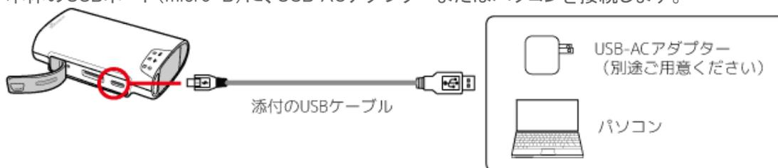
充電が開始されると、
