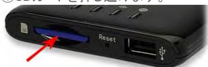
②押し込むと、SDカードが少し飛び出ますので、取り外します。
