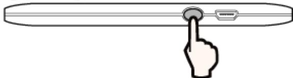
2. [BATTERY]LED、[Wi-Fi]LEDが点灯します。
