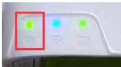
電源を入れるときは、電源ボタンを長押し(3秒間)し「ポケットルーター機能」をONにしてください。短押しは「モバイルバッテリー機能」のON(BATTERY LEDのみ点灯)となり、ポケットルーター機能はONになりません。
