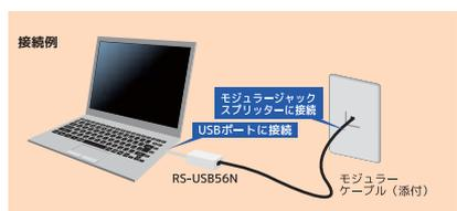
※接続可能な回線は、アナログ一般回線、ISDNのアナログポートです。
