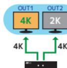
OUT1に接続された機器に対応した解像度・音声フォーマットで出力します。対応していない機器の場合、表示されません。
