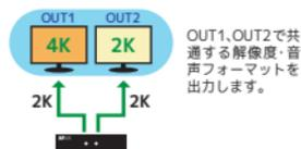
OUT1, OUT2で共通する解像度・音声フォーマットを出力します。
