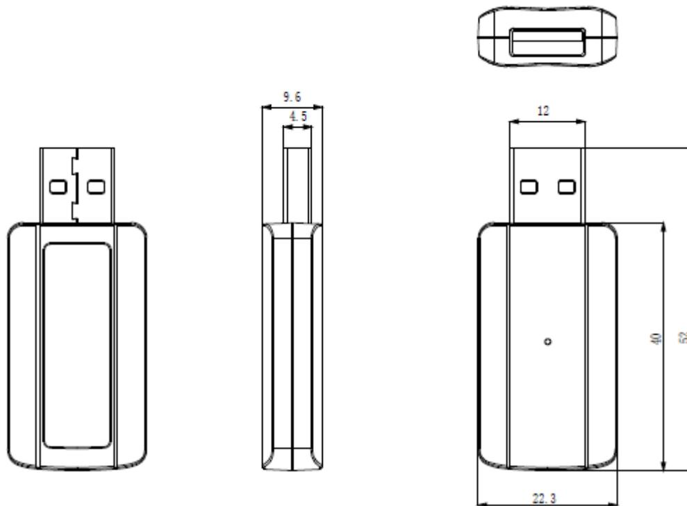
図 2.外形寸法図 ( UNIT: mm )
